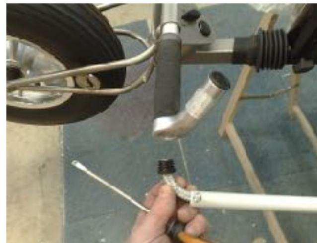
Stick de direction vous permettant de guider le char au démarrage lorsque vous le poussez avant de monter à bord (vous pouvez aisément le faire vous même avec du tube électrique et un morceau de cordage).
