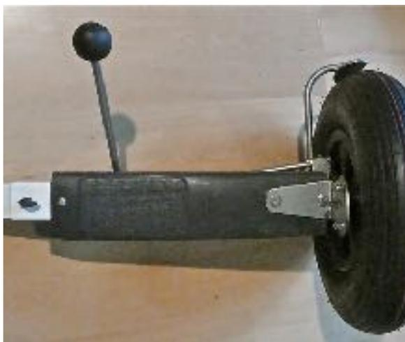
Vous pouvez équiper votre char d'un frein : une manette boule que vous tirez à pleine main et un patin inox vient appuyer sur le pneu, ce frein permet un usage sur toutes surfaces, parking également... Ce dispositif existe pour les petites roues 400x8 ou également pour les grosses roues Dune.
