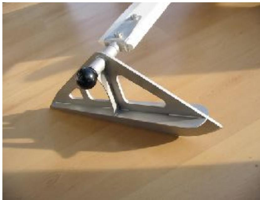
Il existe des **Patins à Glace** : ils se mettent en quelques secondes en lieu et place des roues directement sur les axes d'origine, à l'avant comme à l'arrière .
