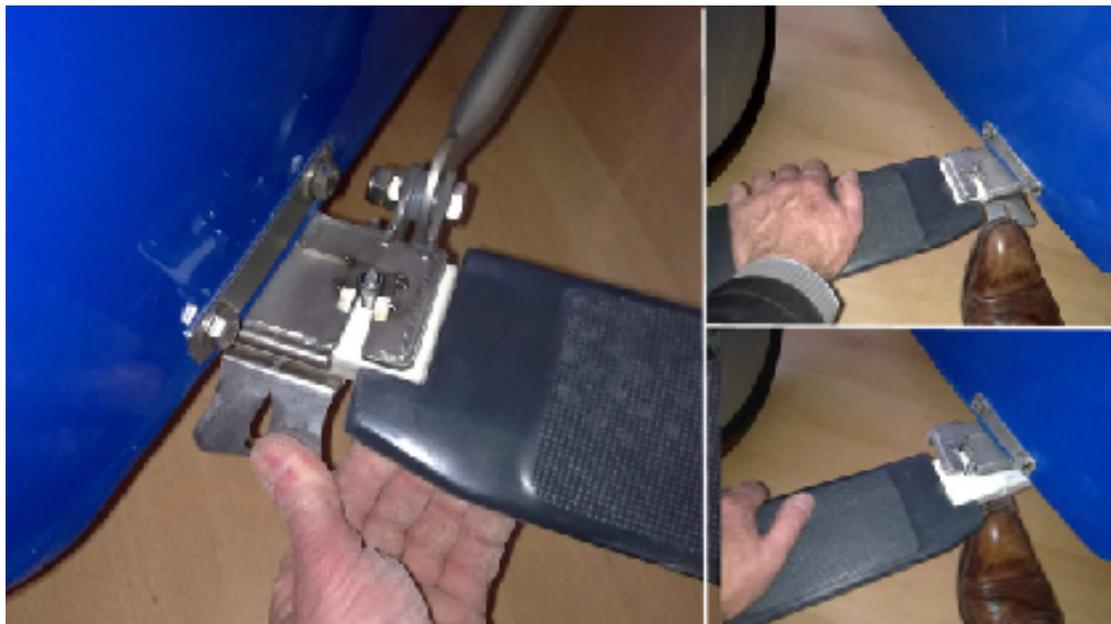
Autre option non proposée tout en haut : système sécurisant de maintien des essieux par clipsage / par lames de ressort :
