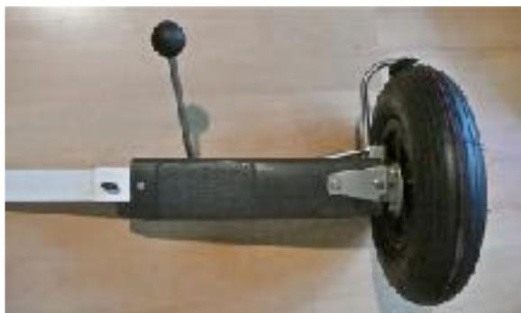
Option frein patin sur pneu : c'est une manette « boule » que vous tirez à pleine main et un patin inox vient appuyer sur le pneu. Ce frein permet un usage sur toutes surfaces, parking également, existe pour les petites roues 400x8 d'origine et également pour les grosses roues Ballon.
