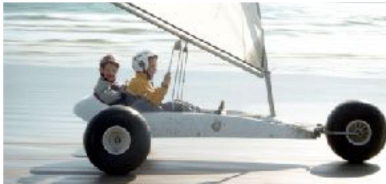
2 roues arrière Ballon type “Dune” à la place des petites permet d'évoluer sur des surfaces moins roulantes
