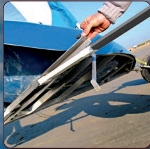
Châssis inox ceinturant la coque Essieux vite montés/démontés
