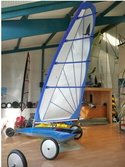
Voile d'origine de l'EXELOR : 6 M2 mylar translucide, décoration bleue.
